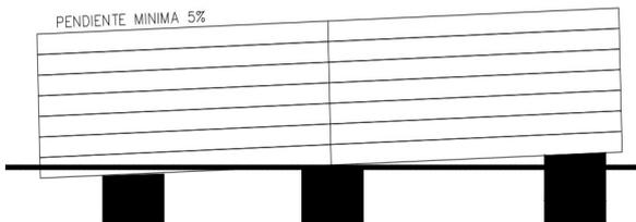
Para evitar la condensación en la superficie interior de la cubierta evite los espacios cerrados herméticamente.
