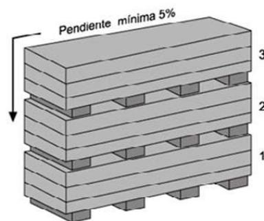
Las cubiertas deben almacenarse en lugares firmes, con una ligera inclinación utilizando apoyos de madera seca, con una altura mínima sobre el piso de 5.0 cm.
