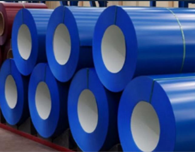
Lámina prepintada G40, su materia prima a la cual se le aplica en una línea de inmersión en caliente una aleación ternaria de 55% de aluminio, 43,5% de zinc y 1.5% de silicio, todo denominado galvalume, lo cual permite una mayor resistencia a la corrosión.
